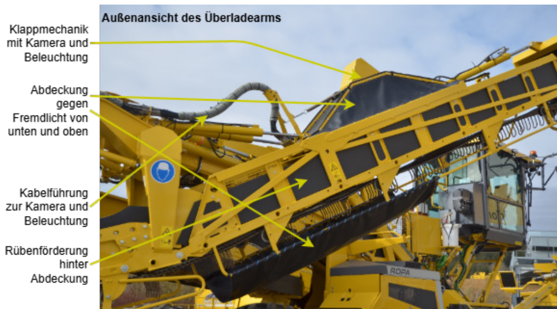
Abbildung 4 zeigt die einzelnen, an der Bildaufnahme beteiligten Komponenten am Arm der Überlademaschine von außen.
