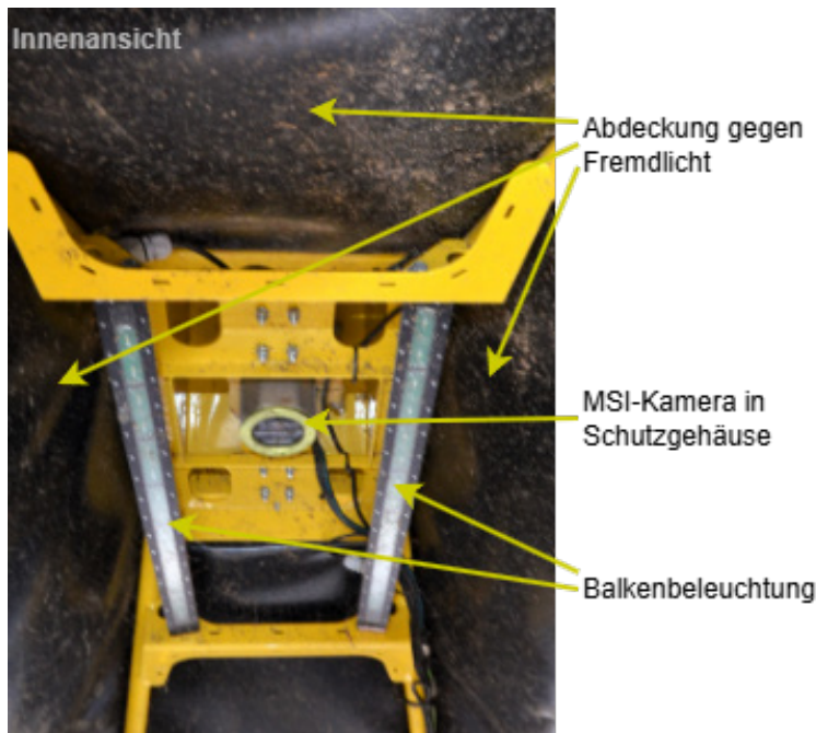
Abbildung 5 zeigt die an der Bildaufnahme beteiligten Komponenten unterhalb der Abdeckung.
