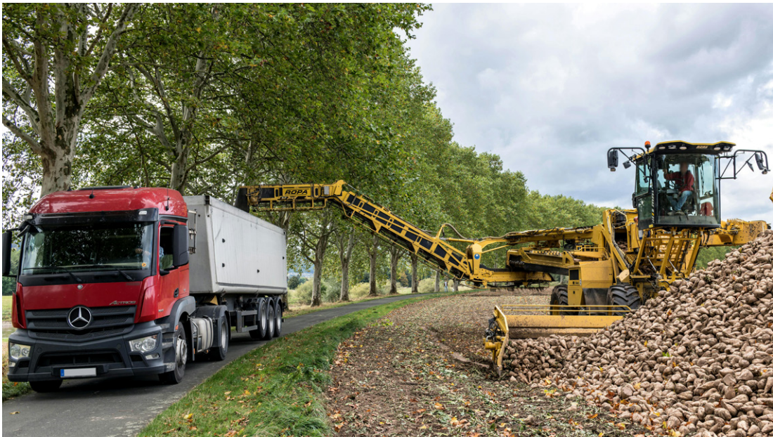
Abbildung 2 zeigt die Überladung einer Zuckerrübenmiete auf einen LKW nach der Ernte im Herbst mithilfe einer Überlademaschine des Herstellers ROPA. [2]
